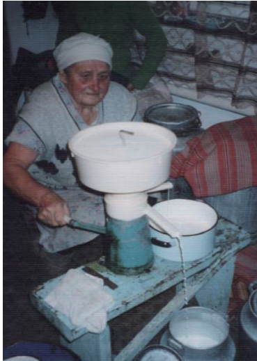
写真5 1950年頃からカザフスタンに普及しはじめた手動式セパレーターによるクリーム の分離。
