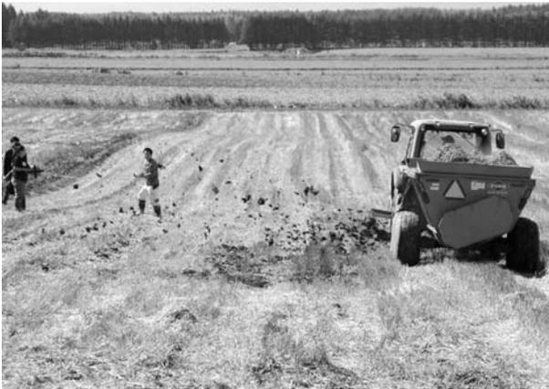
図1 マニユアスプレッダの散布状態と受け箱の回収作業
