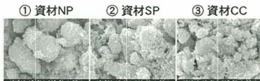
図 2 電解放射型走査電子顕微鏡による撥水加工肥料資材（カバー資材）の表面観察画像（撮影倍率 30,000 倍）
