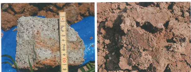
写真3 切り土部分の下層から取り出した風化れき(左)と盛り土部分の下層から取り出した土塊(右)
