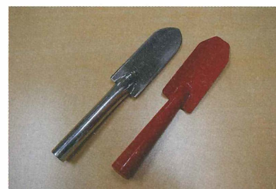
写真1 土壤断面の整形に用いる専用の移植ごて（左：市販品、右：特注品）
