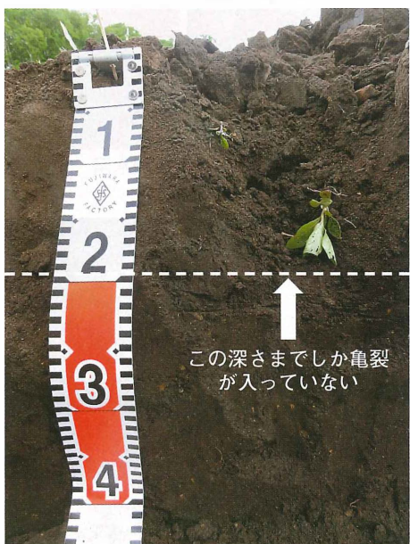
写真 時速5kmで深さ30cmまでサブソイラをかけた断面（速いとチゼルが上下に動くため深さ20cmまでしか亀裂が入っていない）
