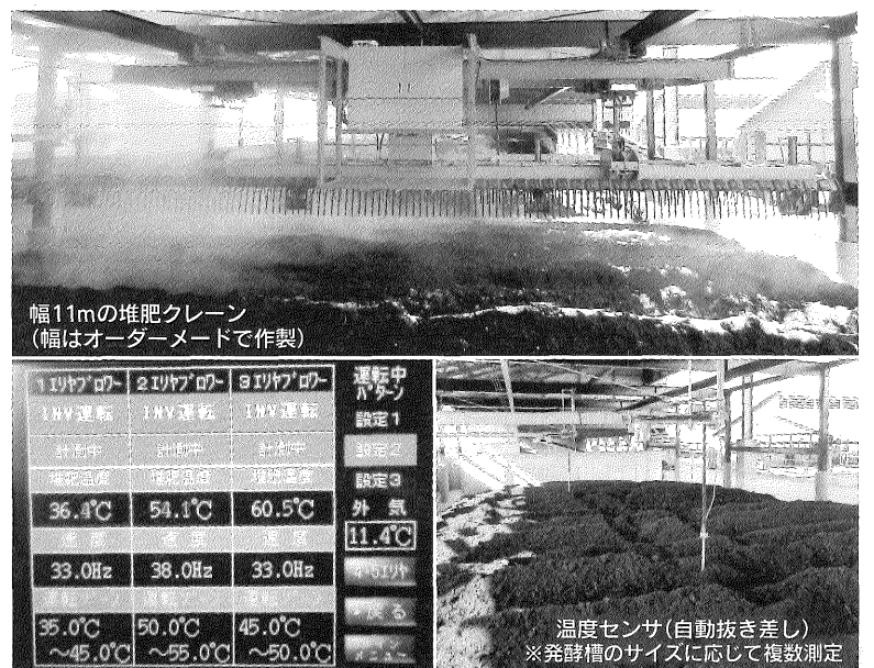
図2 堆肥クレーン(上)、通気量自動制御システム(左下)、温度測定システム(右下)
