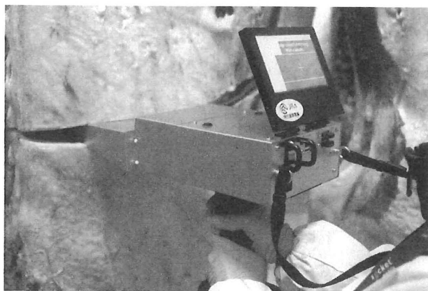
図5 狭い切開面に対応した新しい枝肉横断面撮影装置 (MIJ-15)
