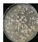
PUR指サックの分解試験
