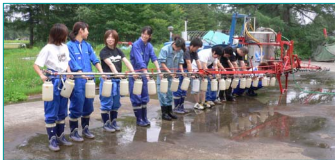
学生実習による散布パターン測定
