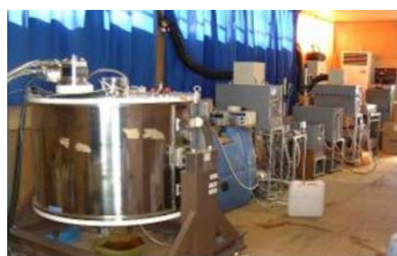
高勾配磁気分離装置と電解酸化による廃水処理 (東京都立大学渡辺教授提供)
