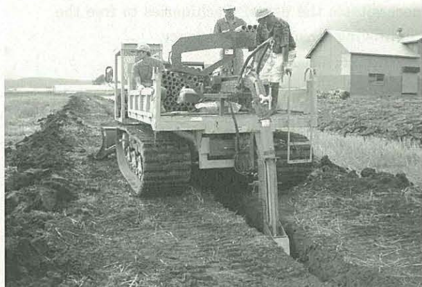
図1 暗渠土管自動敷設機の外観
