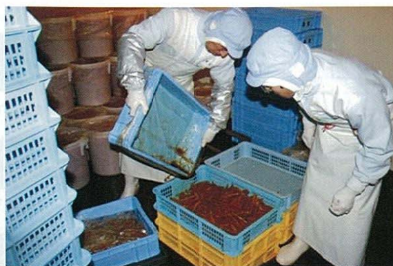
図2：左：調味液への漬け込み工程終了後の液切り工程，右：計量・包装工程
