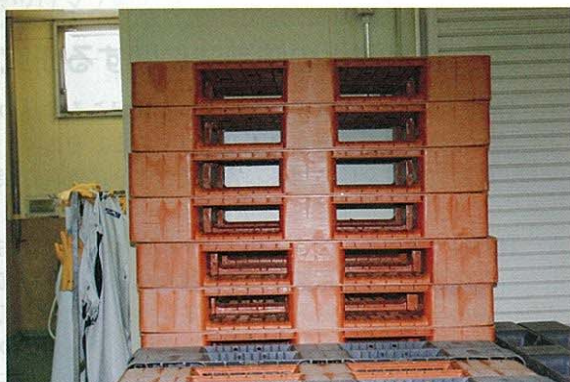
図1：左：洗浄後収納されたパレットの状態，右：白色斑点状に見えるバイオフィームから検出された
