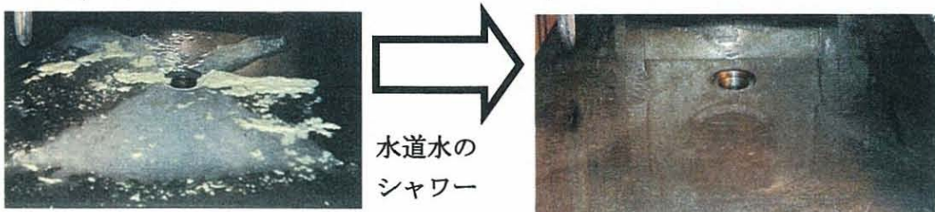
加熱終了後の装置汚染状態
