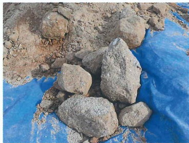
写真3 C層から取り出した十勝溶結凝灰岩の半風化歪角れき
