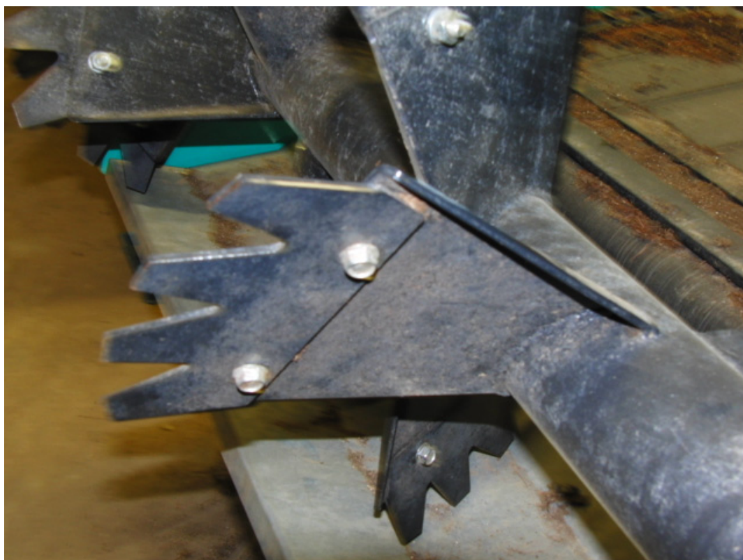
図 23 供試機の鶏冠型のビータ
