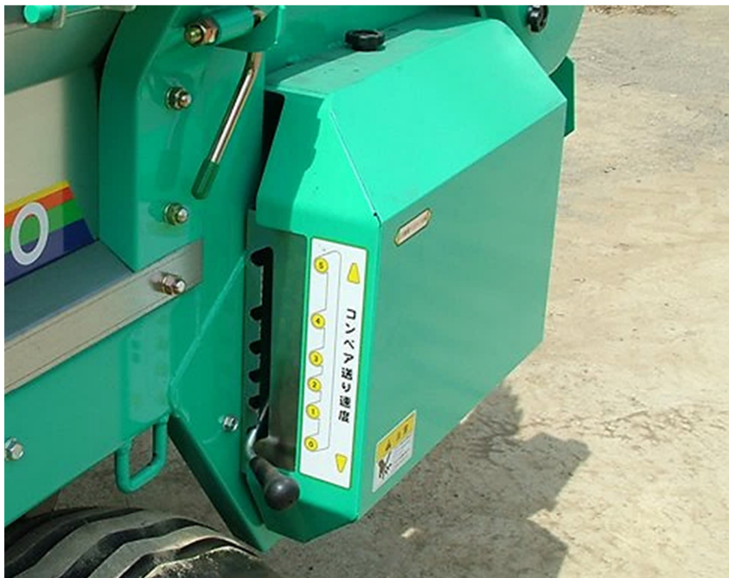
図 3 コンベア送り速度調整用レバー
