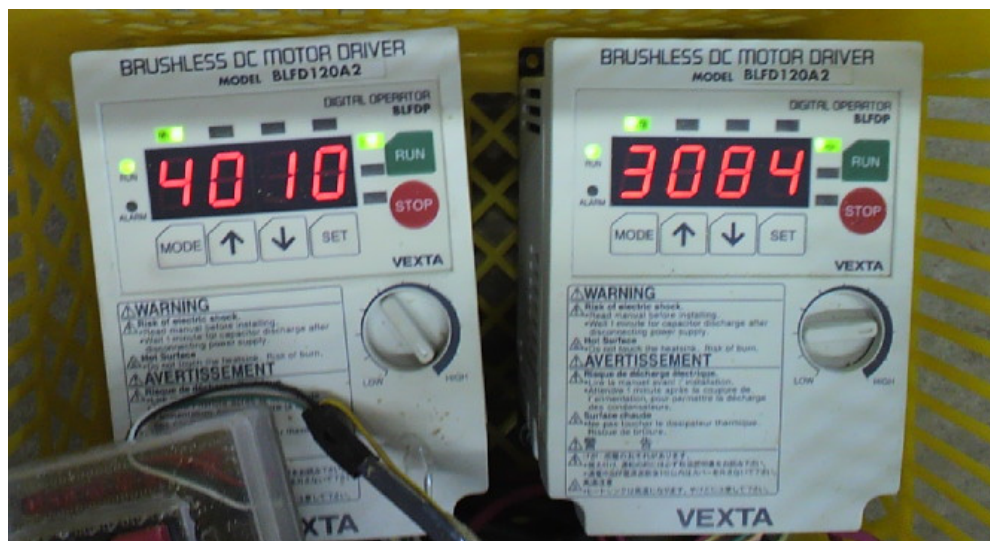
図 18 上下ピータ用モータの制御ユニット
