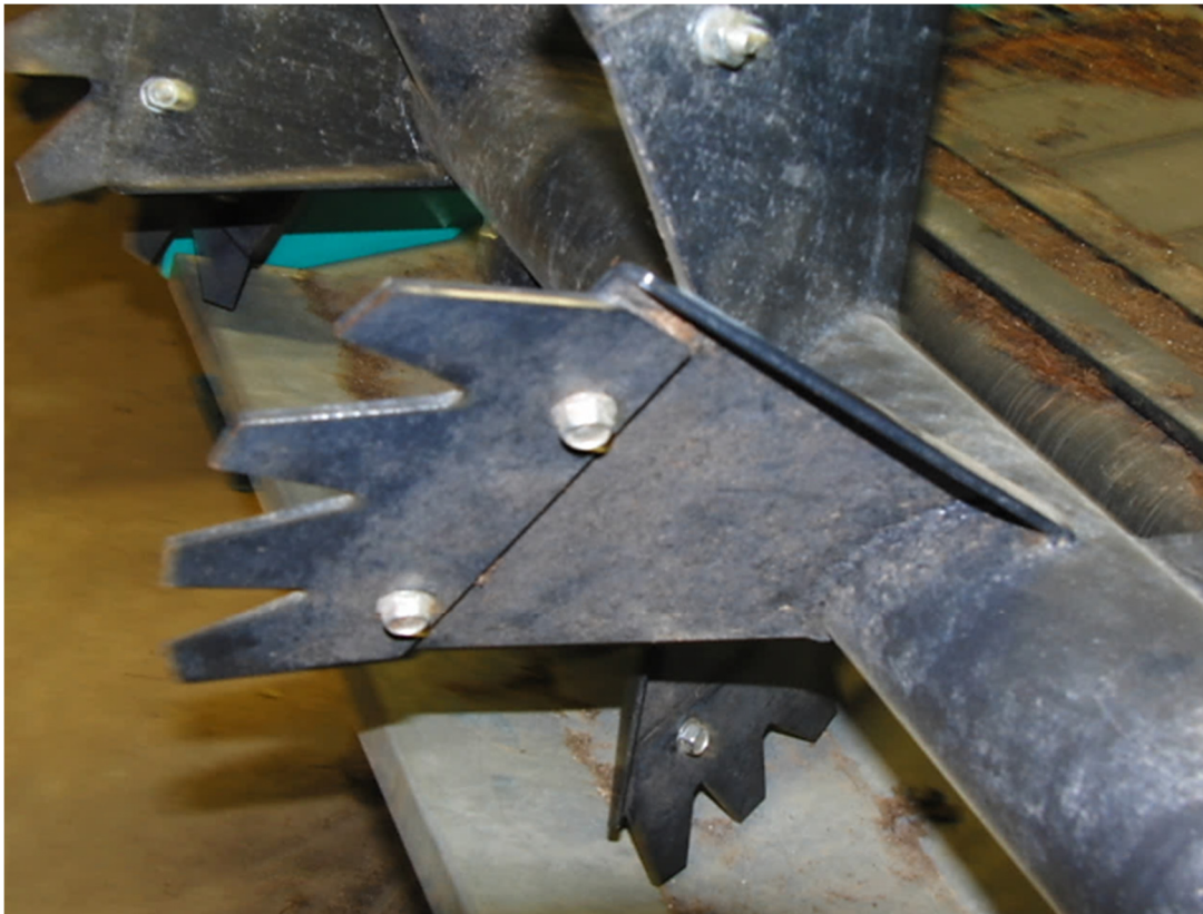
図 4 供試機の下部ビータの写真
