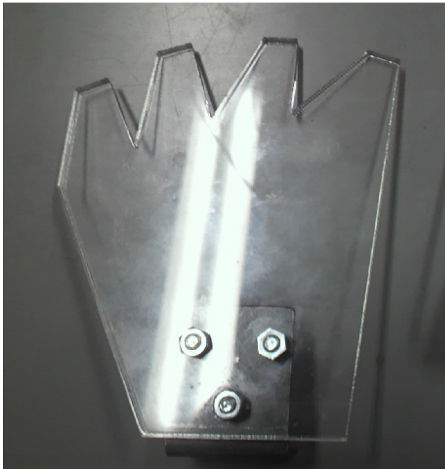
図 24 スケールモデル用のアクリル製ビータ
