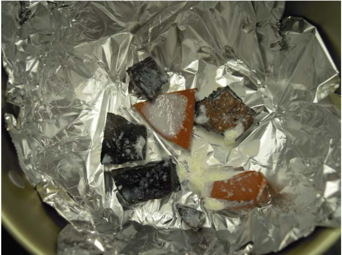
図 11. 鍋から土器片をだし、自然乾燥させる。これらの作業を 10 回繰り返す。
