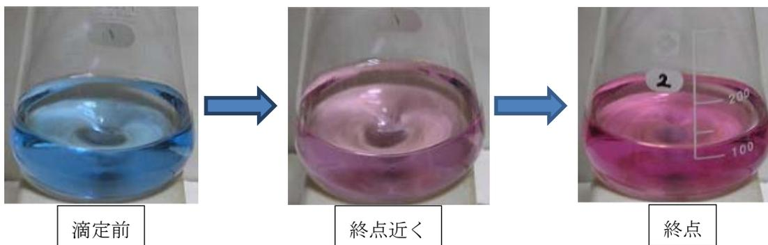
図 1. 中和滴定法における MM 混合指示薬滴下後のサンプルの変色反応
