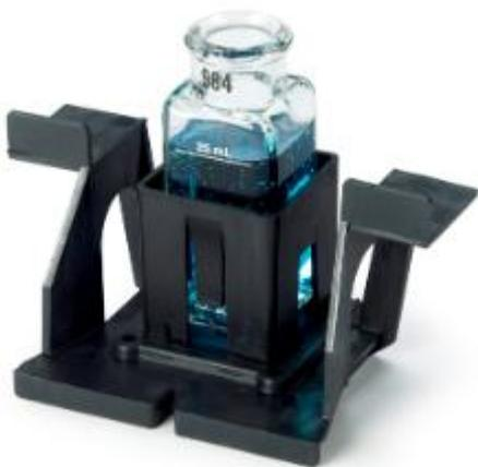
図 3. 試料測定用バイアル瓶と設置パーツ
