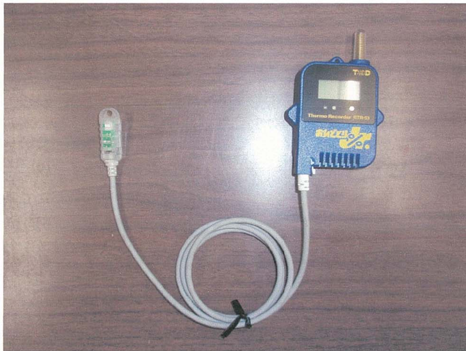
図 - 5.2 ビニールハウス内で使用した自記温湿度計
