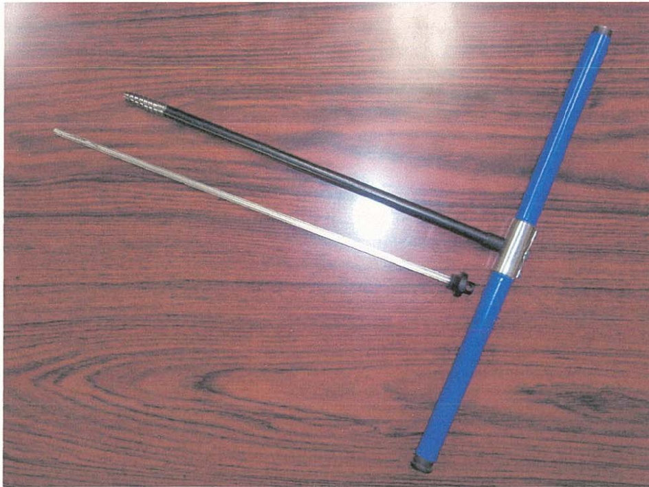
図 - 14 樹齡の測定に用いる機器
