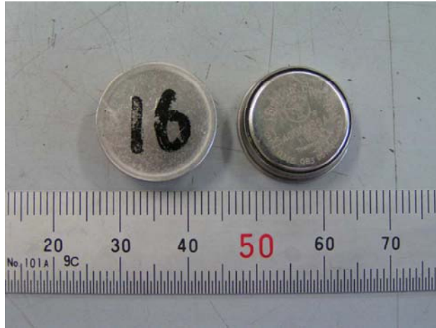
図 4. 温度測定に用いたデータロガー（合資会社 KN ラボラトリーズ，サーモクロン G タイプ）
