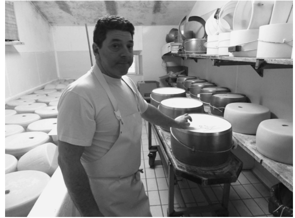
図3 パルミジャーノ・レッジャーノの加塩。塩水に漬けて加塩する (左側の水槽)。かつては、直接に粗塩を擦り付けて、加塩していた。右手の棚の上にあるプラスチック製の型枠が、最初に麻布ごと凝乳を入れて脱水する容器、職人が手に触れている金属製の型枠が、その次に脱水を進める容器。
