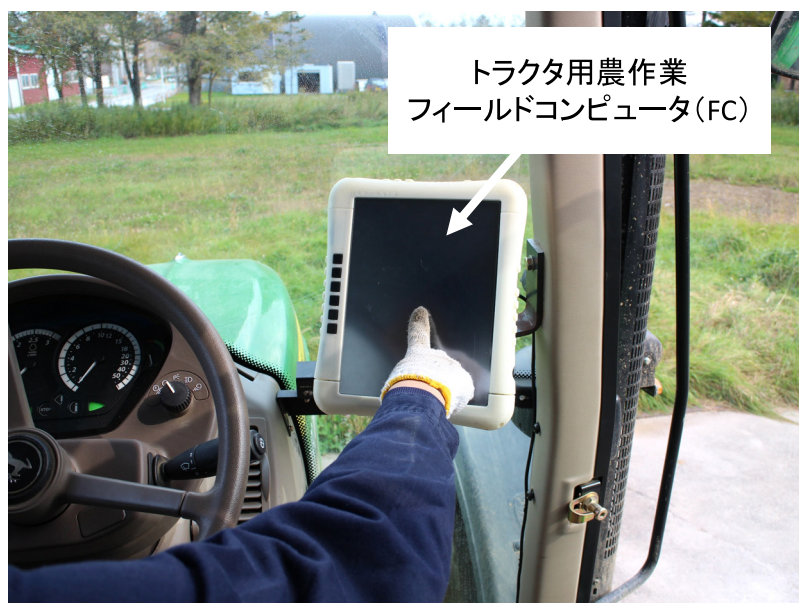
図2 試作したトラクタ用農作業フィールドコンピュータの外観
