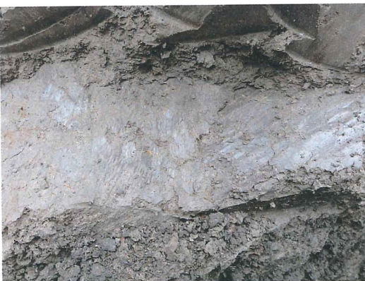
写真2 構造面に光沢を持ち、条線の入ったスリッケンサイド
